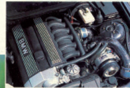
Dampfgesänge: Mit Antriebsrasseln macht der Kompressor (rechts unten) auf sich aufmerksam
