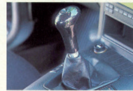
Per Wippschalter auf dem Schaltknopf läßt sich zu jedem der fünf Gänge ein Overdrive belegen
